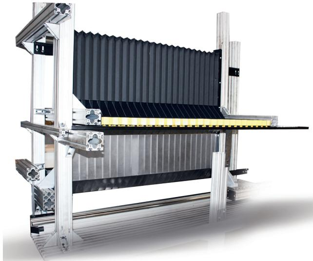
Bild 1. Getestet werden unter anderem das Knickverhalten der Materialien und der Verschleiß der Gleitbeziehungsweise Rollenführungen.
